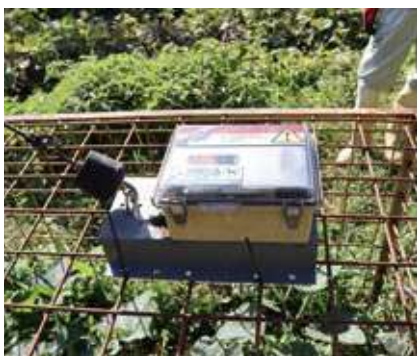
檻の上に設置された自動捕獲装置 アニマルセンサー2 (株式会社アイエスイー製)
