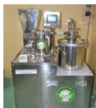
最新の湿式気流製粉機
