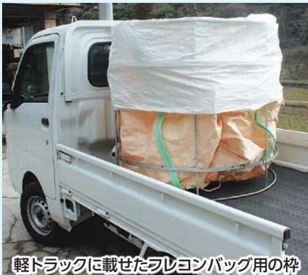
軽トラックに載せたフレコンバッグ用の枠
