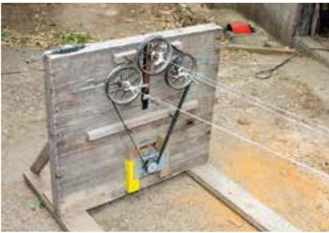
手押し車のホイールや洗濯機のモーターを組み合わせて作製した「自動でよりを掛ける機械」
