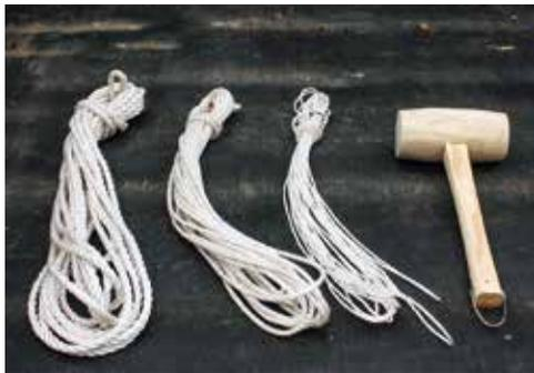
手作りのロープと小槌。ロープはひもの本数を変えることで用途に応じた3種類が製作可能
